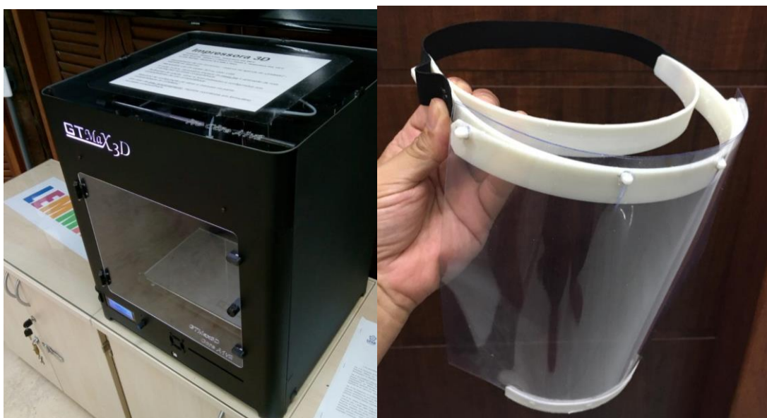
Figura 2 – Impressora 3D utilizada no LEMMAC para a produção e face shield .
