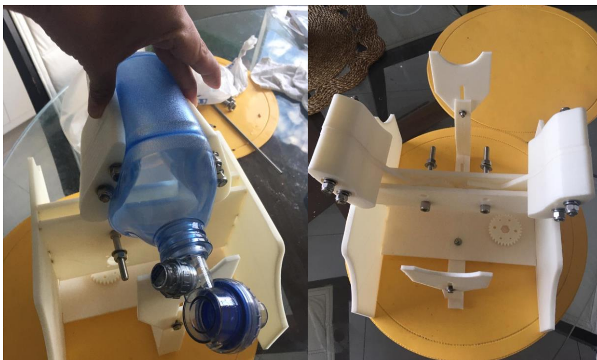
Figura 2 – Protótipo de ambuzador produzido no LEMMAC (com e sem ambu, respectivamente).
