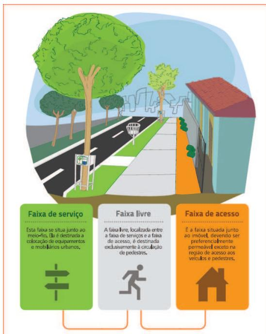
Figura 2. Vista esquemática
