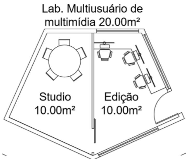
Figura 10: Planta do Laboratório multiusuário de multimídia. Fonte: Setor de Projetos/ DINFRA/ PROPA UFSB, 2020.
