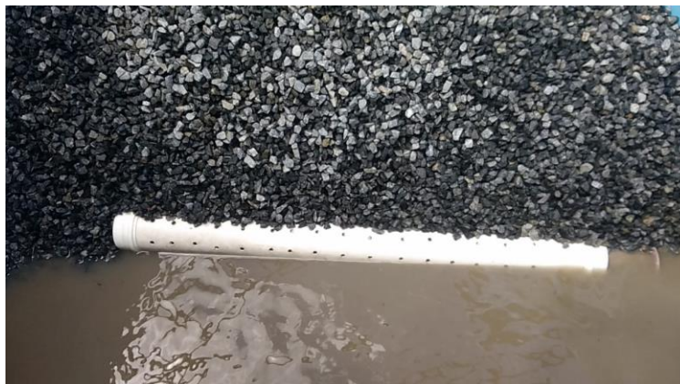
Figura 4.6 – Camada de brita e dreno para filtração da água pós aeração e decantação
