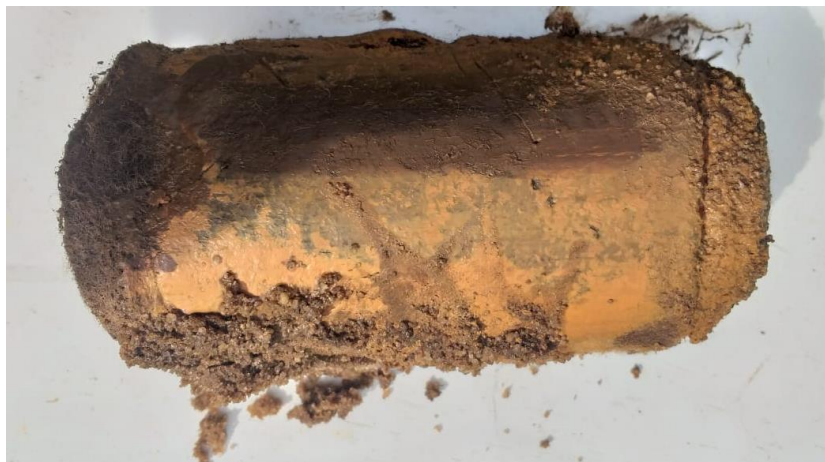
Figura 5.8 – Manta acrílica perlon retirada do segundo filtro, impregnada de ferro
